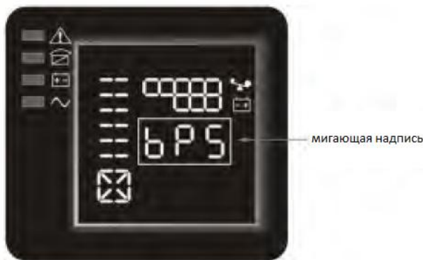
Рисунок 6 – Настройки режима Bypass
