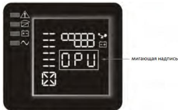
Рисунок 7 – Настройки режима Output voltage
