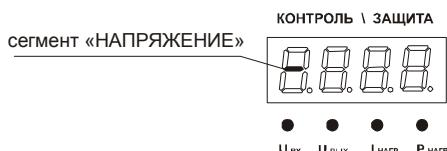
Если ток нагрузки превышает табличное значение более чем на 5%, то через некоторое время, определяемое характеристикой отключения К, стабилизатор отключится (при коротком замыкании в нагрузке отключение стабилизатора произойдет в течение 20 мс), и включится сегмент «ПЕРЕГРУЗКА» индикатора.
