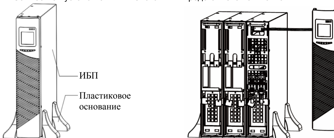
Рис.16 Установка ИБП и внешних аккумуляторных блоков
