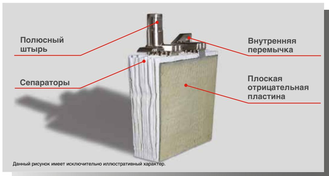
В АККУМУЛЯТОРАХ FIAMM FLB ПРИМЕНЯЕТСЯ ТЕХНОЛОГИЯ AGM (ABSORBED GLASS MAT – ПОРИСТЫЙ ЗАПОЛНИТЕЛЬ ИЗ СТЕКЛОВОЛОКНА). ЭЛЕКТРОЛИТ ПОЛНОСТЬЮ ВПИТЫВАЕТСЯ В СТЕКЛОВОЛОКОННЫЙ СЕПАРАТОР, ЭФФЕКТИВНОСТЬ РЕКОМБИНАЦИИ ГАЗОВ СОСТАВЛЯЕТ 99%. БЛОКИ ОТЛИЧАЮТСЯ ПРОЧНОСТЬЮ, ГЕРМЕТИЧНОСТЬЮ И НЕ ТРЕБУЮТ ДОЛИВКИ ЭЛЕКТРОЛИТА В ТЕЧЕНИЕ ВСЕГО СРОКА СЛУЖБЫ. НИЗКИЙ УРОВЕНЬ САМОРАЗРЯДА ПОЗВОЛЯЕТ ХРАНИТЬ БАТАРЕИ БЕЗ ЗАРЯДКИ ДО 6 МЕСЯЦЕВ.
