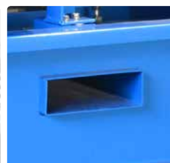
Гнездо для вилочного погрузчика
