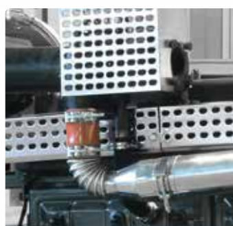
Защитные решетки на горячих деталях двигателя
