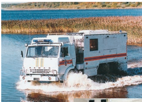
Аварийноспасательная машина АСМ 41 с электроагрегатом 6 кВт производства НПО "Сатурн" (г. Рыбинск)
