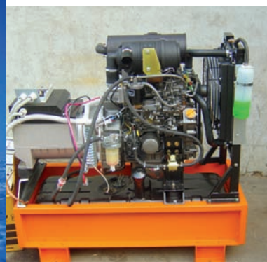
АДС 10 - 230 РЯ работает в условиях крайнего севера (полуостров Ямал) на супервездеходе "Витязь" в составе трех электроагрегатов
