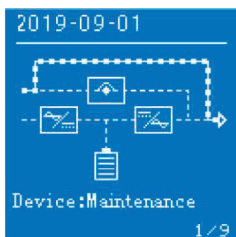
Рис. 4-7. Выход обходной линии для технического обслуживания
