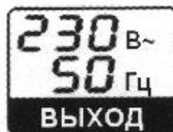
На ЖК-дисплее отображается значение выходного напряжения (230V) и выходной частоты (50Hz).
