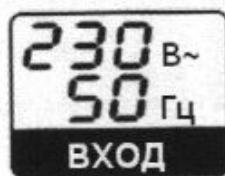
На ЖК-дисплее отображается значение входного напряжения (230V) и входной частоты (50Hz).
