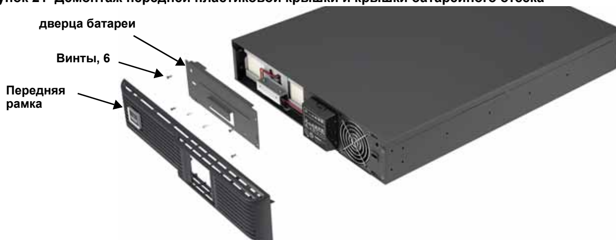
Рисунок 21 Демонтаж передней пластиковой крышки и крышки батарейного отсека
