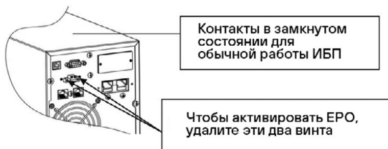
Рисунок 3. Разъем аварийного отключения EPO
